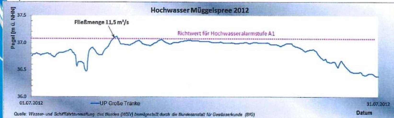
Bei Fließmengen die heute zu Hochwasser führen lagen in den 80iger Jahren die Gewässerpegel der Müggelspree noch um ~80 cm unter dem Richtwert der Hochwasseralarmstufe 1.
